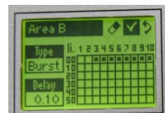
Création de rafales, ici de la ligne 3 à la ligne 10 , temps 0.1s
